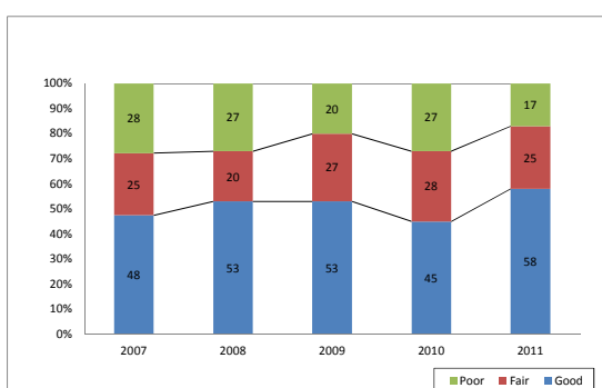
図 7 舗装州道路の道路状態
