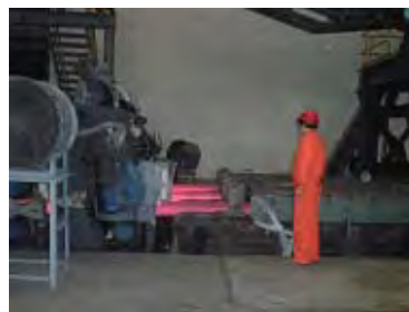
連続鋳造設備
