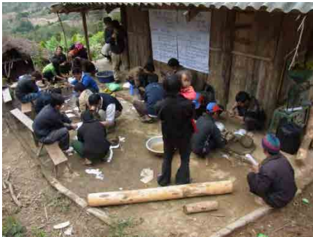
Người dân tham gia lớp tập huấn đang làm phần phía trên của buồng đốt của các bếp tên lửa bằng cách sử dụng khuôn bằng vỏ phích (ảnh trên bên trái). Bếp tên lửa có thể di chuyển được (ảnh trên bên phải)
