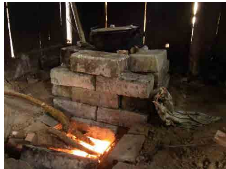
Bếp tên lửa được lắp đặt trong vòng 30 phút kể từ khi công việc bắt đầu. Sau khi hoàn thiện, phần bên trong được đốt trong vòng 2 giờ và khô để bếp đạt điều kiện sử dụng hiệu quả.
