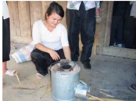
Người dân tham gia lớp tập huấn đang làm phần phía trên của buồng đốt của các bếp tên lửa bằng cách sử dụng khuôn bằng vỏ phích (ảnh trên bên trái). Bếp tên lửa có thể di chuyển được (ảnh trên bên phải)
