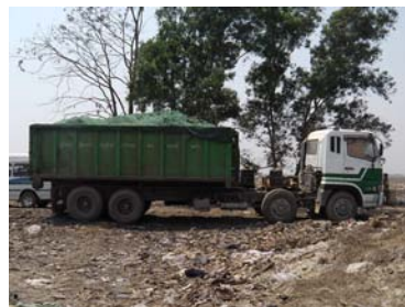
コンテナ搬送車（車体：日本製中古、コンテナ：PCCD製、ごみ積載量：8トン）
