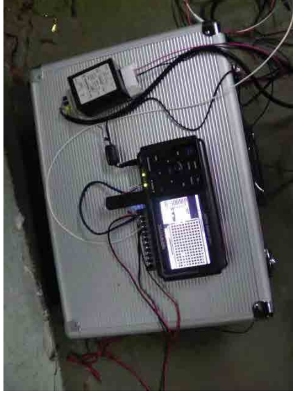
Зураг 4-1-2: Тохиргоо хийгээд хэмжилт хийж буй Data Logger-ийн фото зураг
