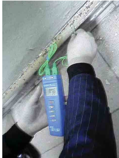
Зураг 4-1-8: Температур хэмжигчээр Хэмжилт хийж буй байдал
