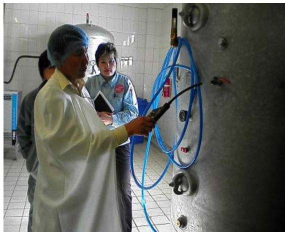
Зураг 2.4-21 Үйлдвэрийн орчинд явагдсан ЭХХ-ийн сургалтын дүр зураг (Ультрасоник механик хий алдагдалт хэмжигч багаж)
