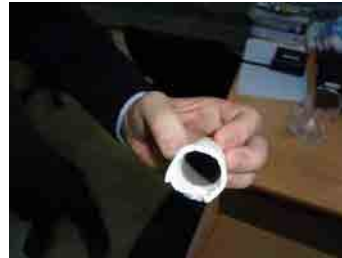
Цилиндр хэлбэрийн фильрт шүүж авсан тоосны дэгж, фильртэй дотор талд тоос шүүгдэж саарал өнгөтэй болсон байна.
