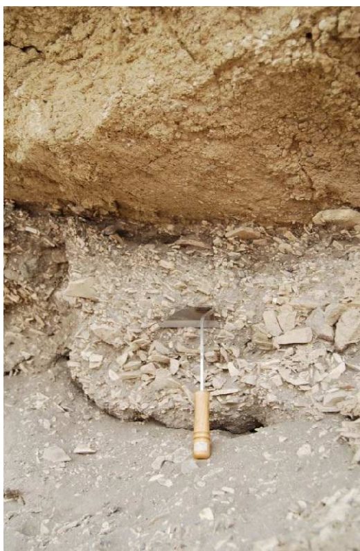
Նկար 3.7-32 Խզվածքի լուսանկար: Վերին և ստորին հատվածքները համապատասխանաբար Մեզոզոյան նստվածքներ են և Չորրորդական նստվածքներ: Չորրորդային նստվածքները բաղկացած են փուխր կոպիձից: Խզվածքի ձգվածությունը N62°W է, իսկ անկումը 17°NE են, իսկ սահման մակերեսի ուղղությունը՝ N20°E:
