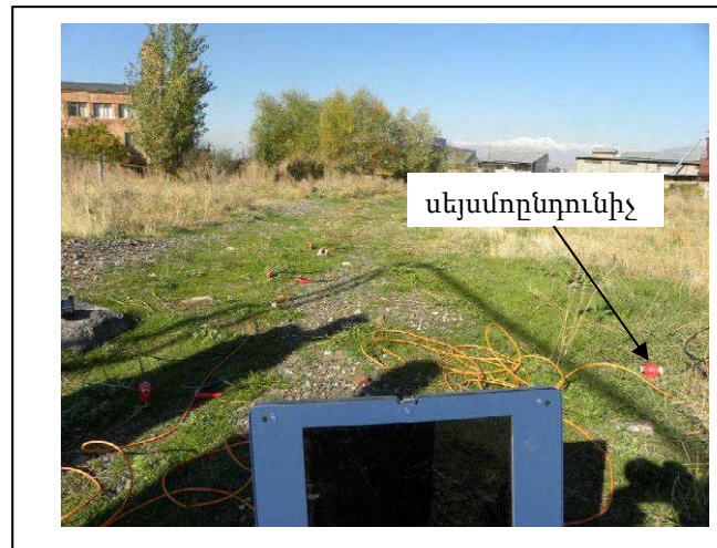
Նկար 3.3-2 Մակերևութային ալիքի հետազոտության համար սեյսմոդրոնիչների L-աձև տեղադրում
