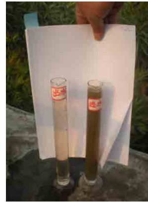
図6 処理前（右）と処理後（左） （嘉興市污水处理場）
