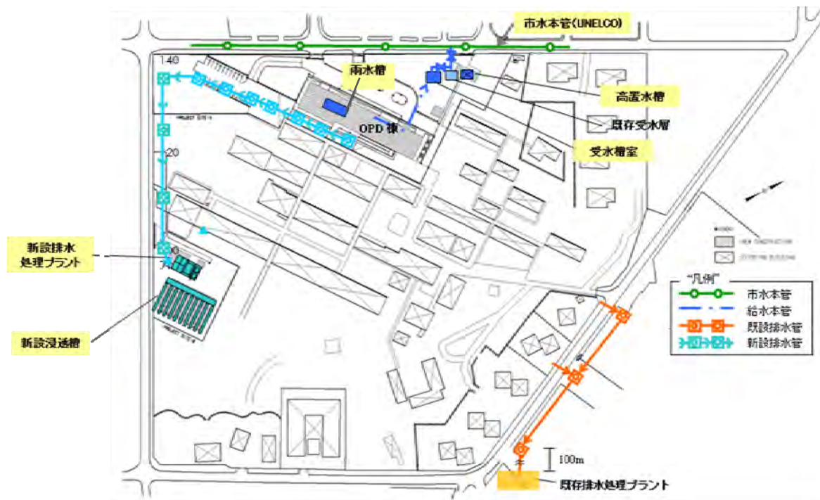
図3-17 給水・排水配管ルート配置図
