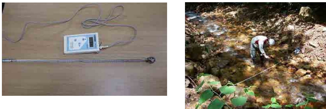
図 7-6 プロペラ式流速計および流量の測定状況
