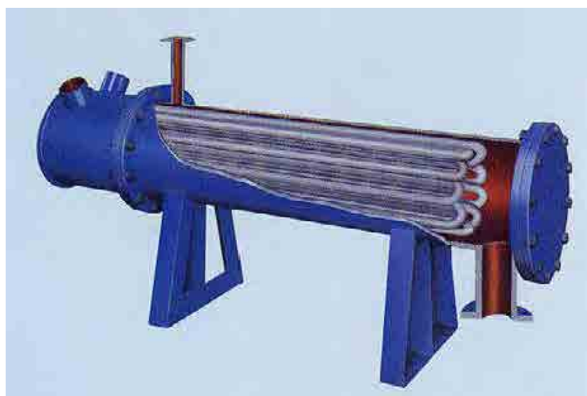
図 10-28 水冷式ダミーロード構造図
