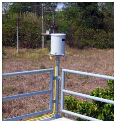
図 9-21 雨量計の設置
